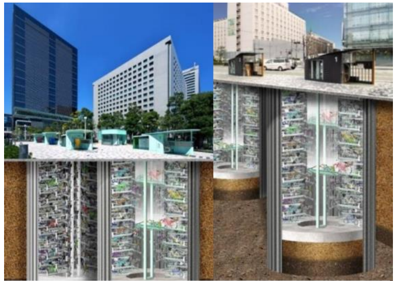
Automatizovaný systém podzemného parkovania bicyklov na stanici Shinagawa v Tokyu
